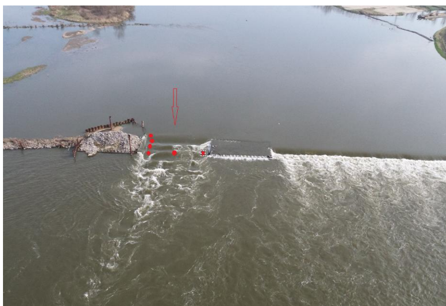
Rys. 4. Schemat przejścia w zaporze Kozienickiej i układ punktów pomiarowych.
